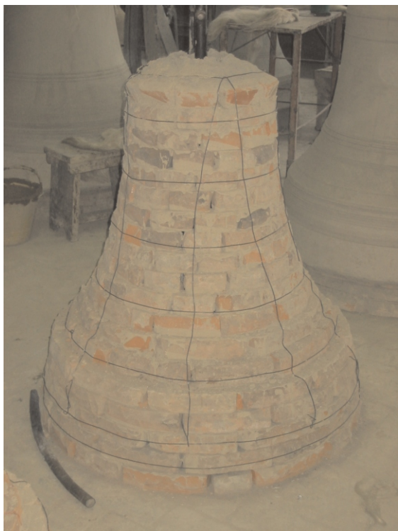
Realizzazione dell'anima che rappresenta l'interno della campana
