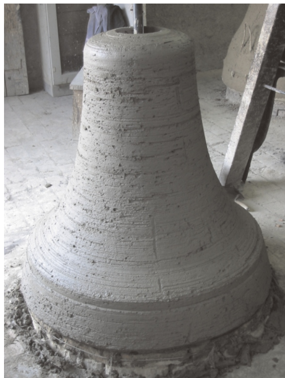
Realizzazione dell'anima che rappresenta l'interno della campana
