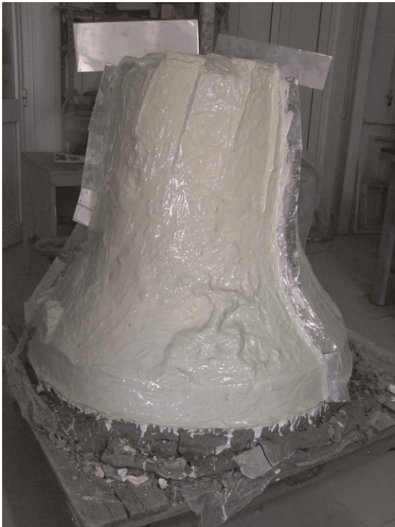
Realizzazione dello stampo in gomma
