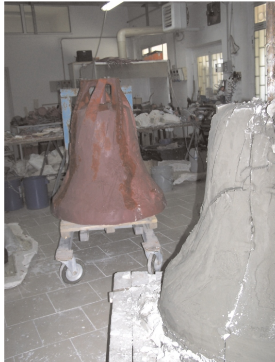
La campana pronta in cera per la fusione
