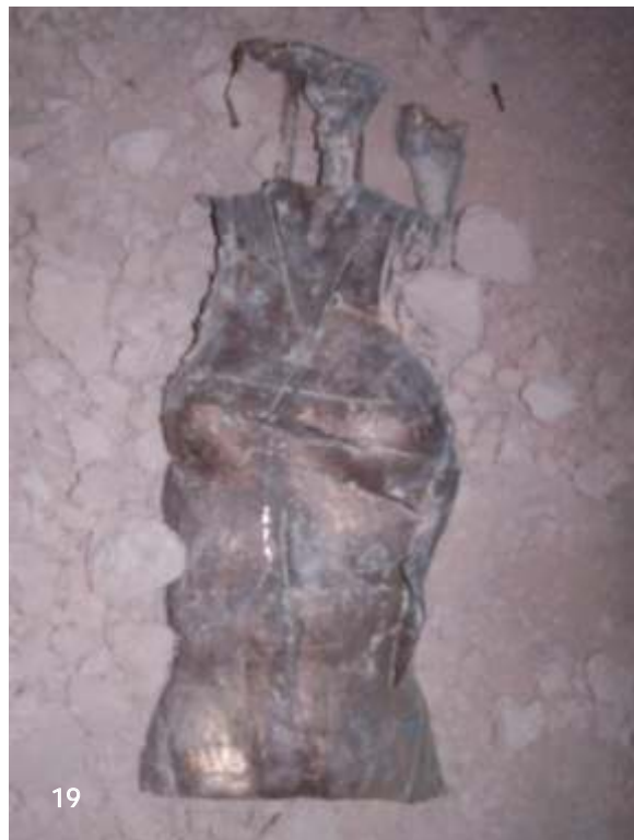
19) il semilavorato in bronzo all'uscita della fusione
