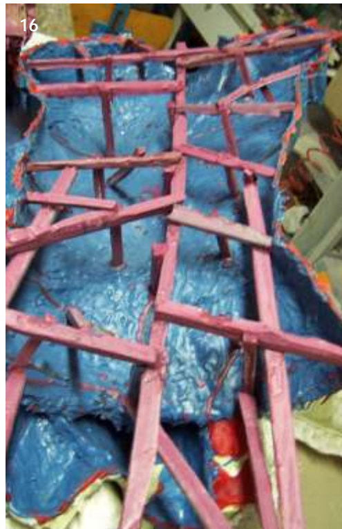
16) particolare: sono visibili i canali per l'alimentazione del bronzo fuso
