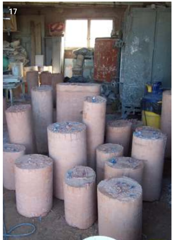
17) i rivestimenti refrattari prima della cottura
